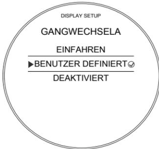
Der Drehzahl-Schwellwert kann festgelegt und zurückgesetzt werden und die Schaltanzeige lässt sich deaktivieren. Sobald der Motor eingefahren ist (bei Kilometerstand 1.600), wird die Option „Einfahren“ durch eine Option „Werkseinstellung“ ersetzt.
