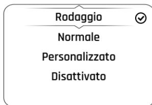
Il regime di rotazione del motore può essere definito e ripristinato. L'indicatore di cambio marcia può essere disabilitato. Non appena il rodaggio del motore viene completato (a 1.600 km), l'opzione Rodaggio viene sostituita con l'opzione Default.
