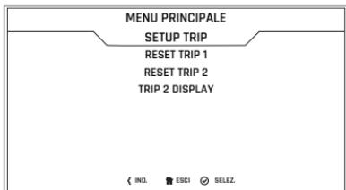
Selezionando RESET TRIP 1 o RESET TRIP 2 è possibile configurare manualmente o automaticamente il contachilometri pertinente. La procedura di impostazione è identica per entrambi i parzializzatori.
