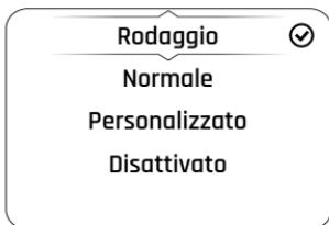
Il regime di rotazione del motore può essere definito e ripristinato. L'indicatore di cambio marcia può essere disabilitato. Non appena il rodaggio del motore viene completato (a 1.600 km), l'opzione Rodaggio viene sostituita con l'opzione Normale.
