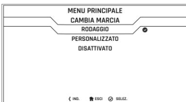
Il regime di rotazione del motore può essere definito e ripristinato. L'indicatore di cambio marcia può essere disabilitato. Non appena il rodaggio del motore viene completato (a 1.600 km), l'opzione RODAGGIO viene sostituita con l'opzione NORMALE.
