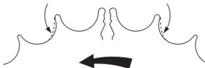
(Desgaste exagerado da roda dentada para fins ilustrativos)
