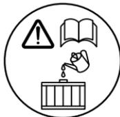
Um eine wirkungsvolle Kühlung des Motors sicherzustellen, prüfen Sie den Kühlmittelstand täglich, bevor Sie mit dem Motorrad fahren, und füllen Sie Kühlmittel nach, wenn der Füllstand zu niedrig ist.
