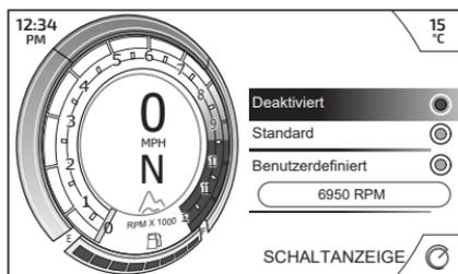
Der Motordrehzahl-Schwellwert kann festgelegt und die Schaltanzeige deaktiviert werden. Sobald der Motor eingefahren ist (bei Kilometerstand 1.600), wird die Option Einfahren durch eine Option Standard ersetzt.
