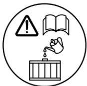
Allo scopo di garantire l'efficiente raffreddamento del motore, verificare ogni giorno il livello del liquido refrigerante prima di usare la motocicletta, e rabboccarlo se il livello è troppo basso.
