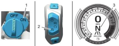
1. Comutatore di avviamento principale - Posizione ON (se in dotazione)
