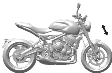
Überprüfen der Vorderradgabel (Trident 660 abgebildet)
