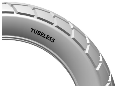
Typische Reifenkennzeichnung - Schlauchlose Reifen
